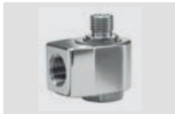
3/8" F : 1/4" M. DN 7. Max. 150 bar / 30 r.p.m. / 90 °C
