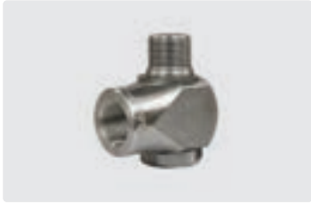
3/8" F : 3/8" M. Max. 400 bar / 30 r.p.m. / 90 °C
