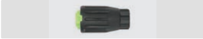
1/4" F. Spray angle 17°. 50 - 150 bar. Max. 60 °C
