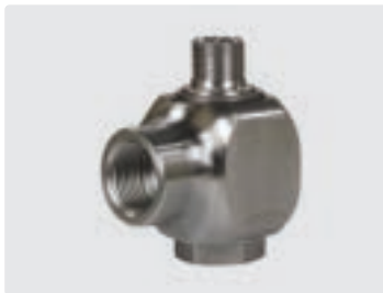
1/2" F : 3/8" M. DN 10. Max. 300 bar / 30 r.p.m. / 90 °C
