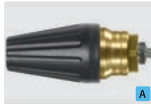
1/8" M. Spray angle 20°. 200 - 400 bar. Max. 100 °C
